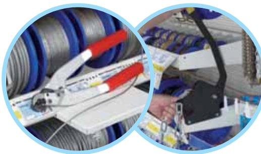
Les outils spéciaux pour chaînes et câbles en acier ou appareils de découpe à chaud pour câbles en plastique permettent d'effectuer des découpes de longueurs en fonction des besoins.
